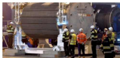
→ L'assemblage de Mox doit être placé dans cette coque pour qu'il puisse être parfaitement armé pendant le transport.
